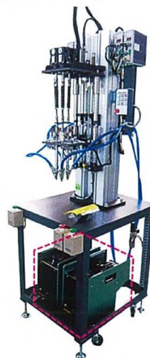
●FF503Hを2台搭載した多軸ねじ締め機
